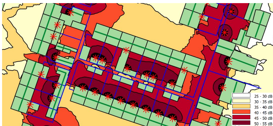
f 5.13 Rijwoningen in Driel - warmtepompen type B, achterzijde
